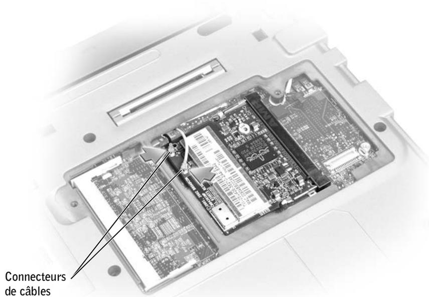
**11** Abaissez la carte Mini PCI vers les pattes intérieures suivant un angle approximatif de 20-degrés.
